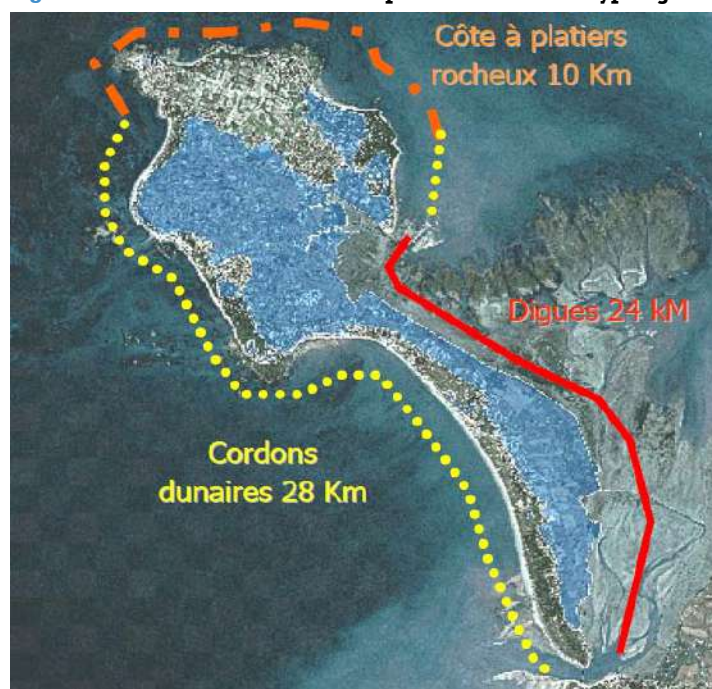
Fig24 Zones situées en dessous des plus hautes eaux et typologie du trait de côte de l'Île de Noirmoutier
